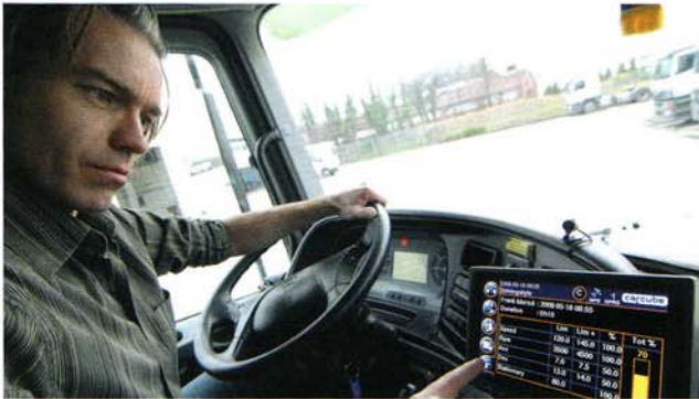
Der digitale Fahrstilassistent signalisiert dem Fahrer, wie er den Treibstoffverbrauch senken kann.
