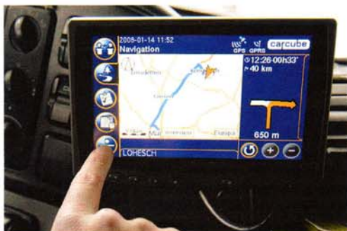
Der Car-Cube von Punch Telematix: Telematik, Telemetrie, Navigation und Telefonie in einem einzigen Gerät
